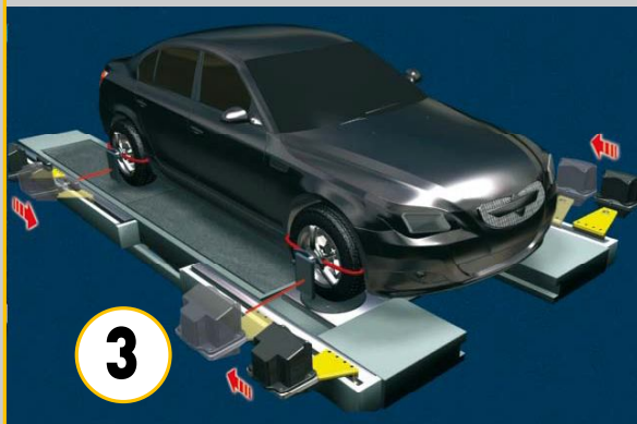
Posizionamento automatico rilevatori e misurazione angoli diretti Automatic positioning of measuring heads and measurement of direct angles Automatische Positionierung der Messwertaufnehmer und Vermessung der direkten Winkel
